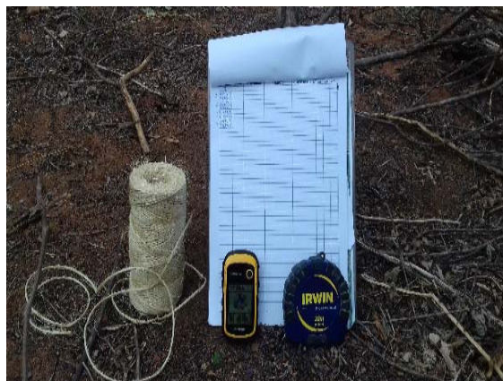
Figura 7 - Equipamentos utilizados para medição e demarcação da Parcela.
